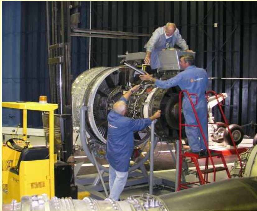
CFM 56-2 montage de la platine pour support du moteur en suspension sur la potence ci-contre le 20/08/2008
