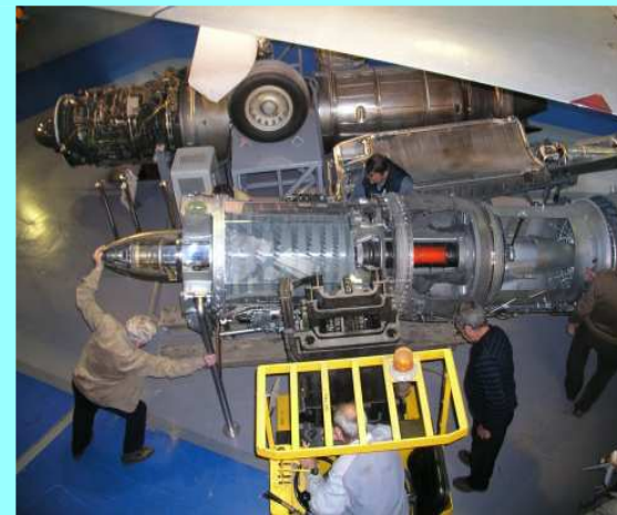
Atar 9C en coupe après pause de protections en plexiglass
