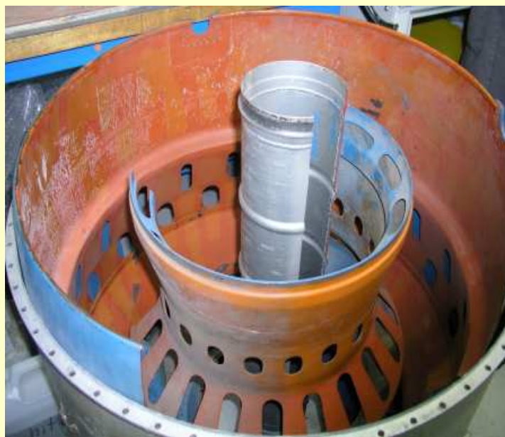
Restauration de l'ATAR 9 B, chambre de combustion (19/03/2019)
