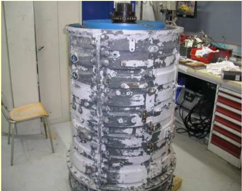
Démontage de l'ATAR 9B, carter compresseur (19/03/2019)
