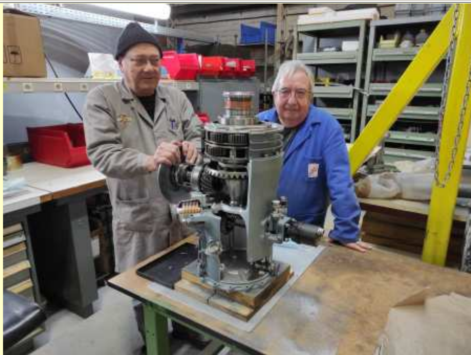
Boite de Transmission Principale de l'Alouette III équipée (19/01/2022)
