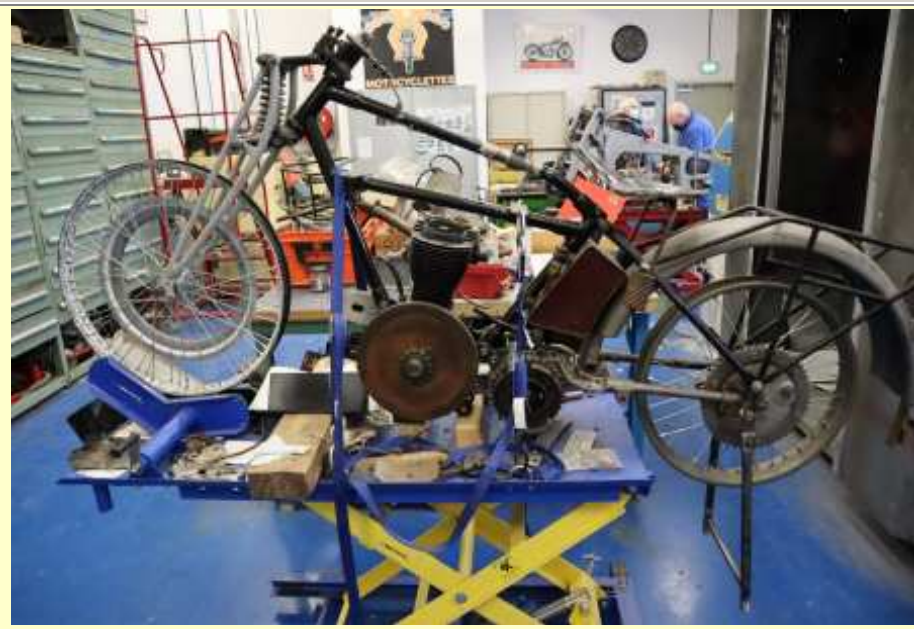
G&R type D 1ère génération: pneus à talon, freins sur poulie-jante (26/01/2022)
