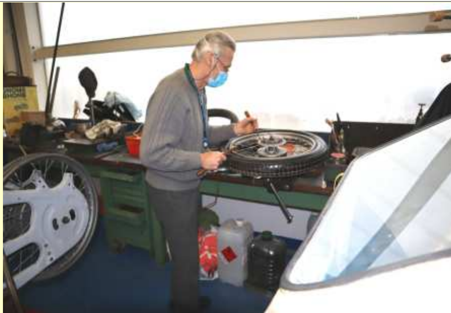
Motos: montage des rayons de roues et des pneus (26/01/2022)
