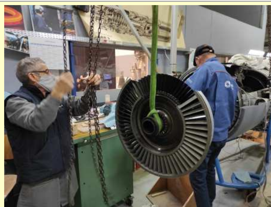
Montage sur l'ATAR 9B en coupe de son arbre de turbine (19/01/2022)
